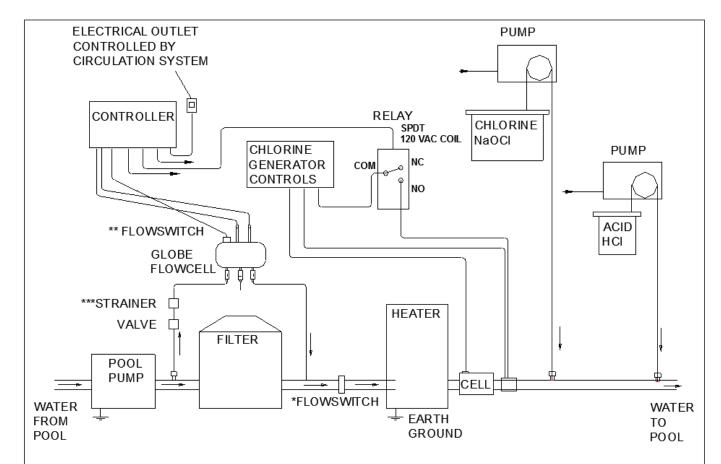
SYSTEM USING ELECTROLYTIC CHLORINE GENERATOR
